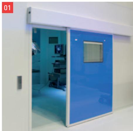
Possibilità di inserimento di una visiva tonda o rettangolare. La visiva viene inserita nell'anta perfettamente sigillata e complanare con iniezione perimetrale di silicone atossico.
