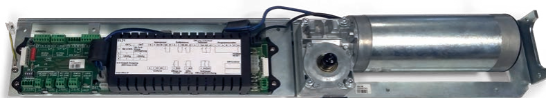
Gruppo comando trazione con motore a doppio avvolgimento e quadro di comando evoluto EL21
